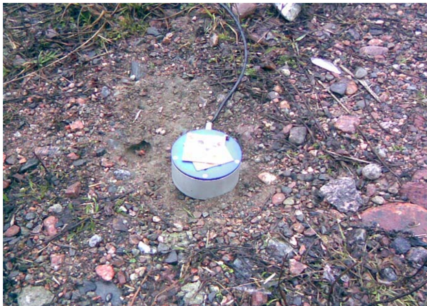
Kuva 7. Kuvassa maahan maapiikillä sijoitettu mittausanturi
